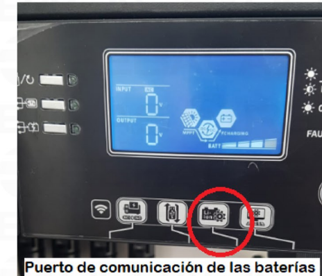
Puerto de comunicación de las baterías
