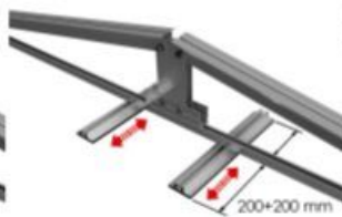
Regulación del portalastre (Ejemplo colocación de portalastre centrado)
