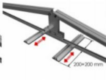
Regulación del portalastre (Ejemplo colocación de portalastre centrado)
